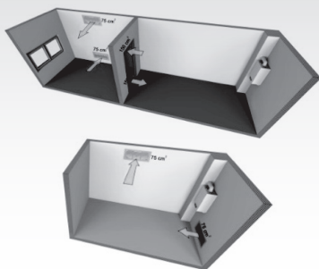
Slika 1.3.1 Soba na priključku tipa B3
